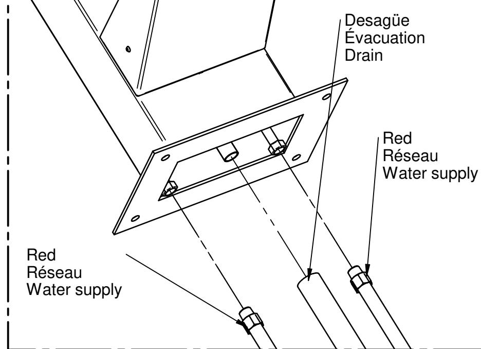
**NOTA:** presión recomendada entre 0,8 y 1,2 bar. Si la presión no es la correcta se debe instalar un regulador de presión. Instalar el reguladro en una arqueta adyacente.
